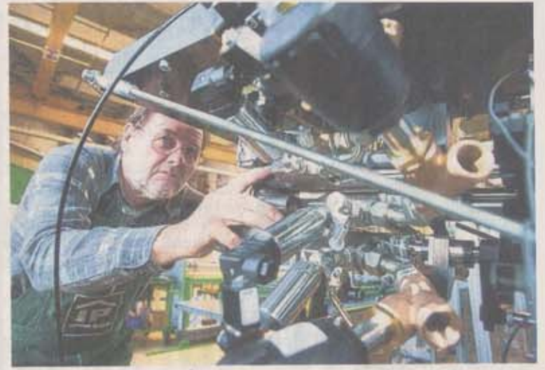
Kompliziertes Einzelstück: Wolfgang Voigt baut an einem Prüfgerät für ein Lkw-Bremsenbauteil.
