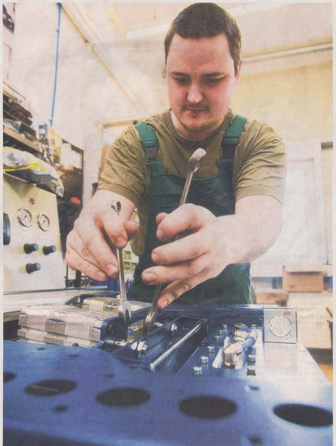
Daniel Reiche justiert eine Abschäleinrichtung, die aneinanderklebende Bleche voneinander per Luftdruck trennen kann und einem Laser zuführt. Fotos (4): Martin Förster
