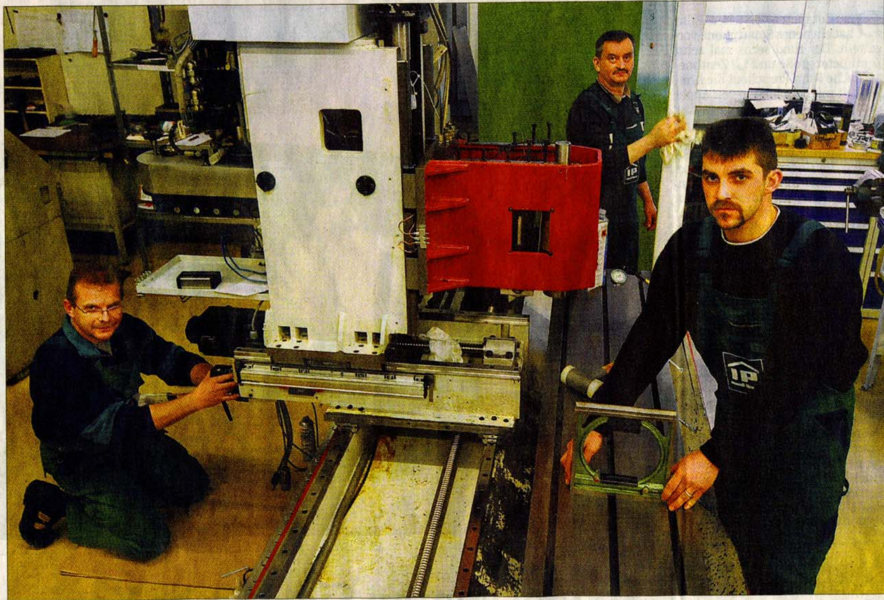
Peter Hirsch, Frank Herrmann und Ralf Holfert (von links) von der IP-Mannschaft sind derzeit mit der Generalüberholung einer CNC-Fahrständerfräsmaschine beschäftigt.
